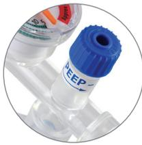
El dial de PEEP permite al médico configurar la PEEP; la ventilación se administra ocluyendo el orificio del dial de PEEP de manera intermitente a la frecuencia respiratoria deseada, lo que permite que se produzca la inspiración y la exhalación.
